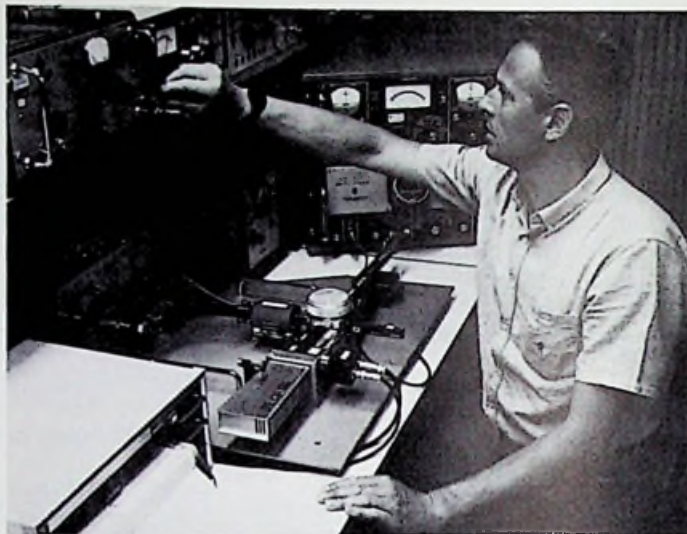
Bild 1: Eichung eines Hohlleiter-Rauschgenerators für 12,4 bis 18 GHz (AEG-Telefunken-Pressbild)
