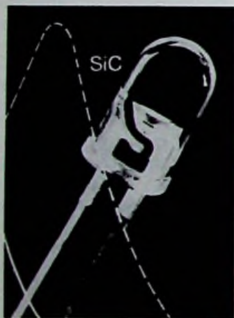
Bild 1: LED aus Siliziumkarbid mit blauem Licht
