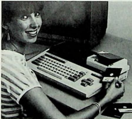
Bild 7: Den bewährten MZ-700 gibt es jetzt auch mit eingebautem Mini-Floppy-Laufwerk (2,8", 2 x 64 KByte). Das Speichern des RAM-Inhalts (64 KByte) dauert 8 Sekunden (Sharp-Pressbild)
