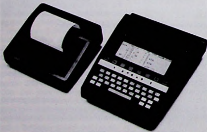
Bild 1: Teletext-Testgerät DTX-1 (Wandel & Goltermann-Pressbild)
